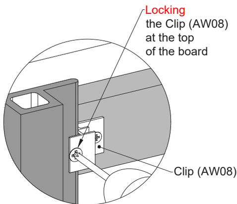
**ONLY ONE LOCKING SCREW TO BE USED PER BOARD**
