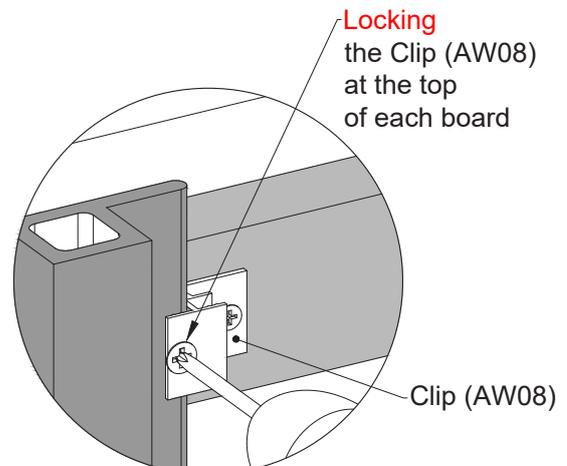
**ONLY ONE LOCKING SCREW TO BE USED PER BOARD**
